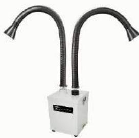
□ E0942A0001 | Дымоуловитель V300E со стандартным фильтром и двумя гибкими дымоприемниками с креплением на блок.<br>В комплект входят:<br>- SYS300E - блок дымоуловителя V300E со стандартным фильтром А1030107 (эффективность 65%) и предварительным фильтром А1030108.<br>- А1020042 – антистатический гибкий дымоприемник 75мм с раструбом-воронкой и фиксатором – 2шт.     |
