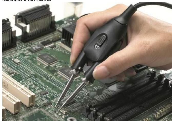
В основе метода SmartHeat лежит нагрев проводника (наконечника паяльника) переменным магнитным полем. Собственно наконечник изготовлен из меди с ферромагнитным покрытием в его хвостовой части, которая в тоже время является сердечником катушки, создающей постоянно действующее переменное магнитное поле.
