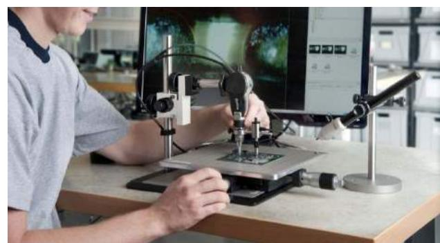
В отличие от всех выпускаемых в мире эндоскопов для BGA-компонентов, только Flexia может работать "с руки" и таким образом применяться для контроля модулей непосредственно в электронных изделиях. При этом, качество изображения настолько высокое, что по форме шариков можно точно оценить работу теромопрофиля и обнаружить возможные дефекты пайки. Контроль BGA можно сделать еще более эффективным, если использовать ПО "Optipix", позволяющее выполнять анализ дефектов и бесконтактные измерения.
