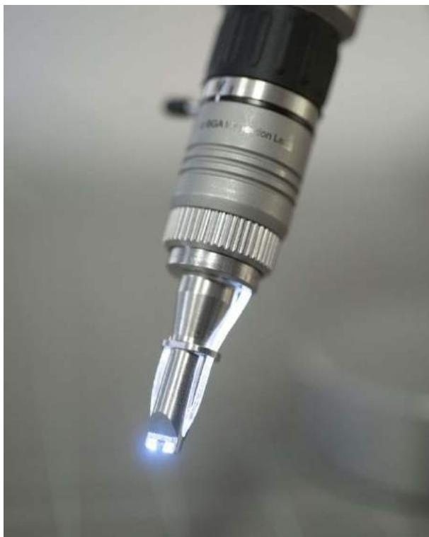
Flexia BGA является более доступной но не менее эффективной альтернативой рентгеновских систем контроля. Также как традиционные рентгеновские системы, Flexia BGA позволяет оператору оценить форму шариковых выводов, обнаружить замыкания, остатки флюса, микротрешины, качество поверхности,
