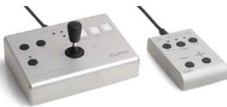
Управление параметрами изображения, такими как яркость, контраст, фокус, диафрагма, четкость, цветность и некоторыми другими, происходит автоматически. Однако оно может осуществляться вручную при помощи программного обеспечения или удобного джойстика многофункционального устройства управления. Во втором случае использование компьютера не обязательно.
